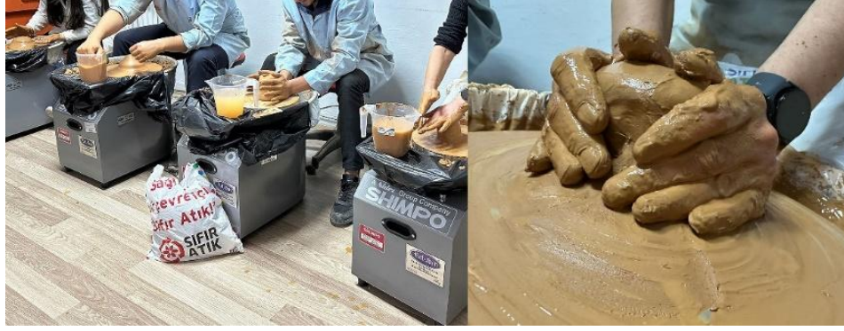
Şekil 1. İlk uygulama: çamur merkezleme
