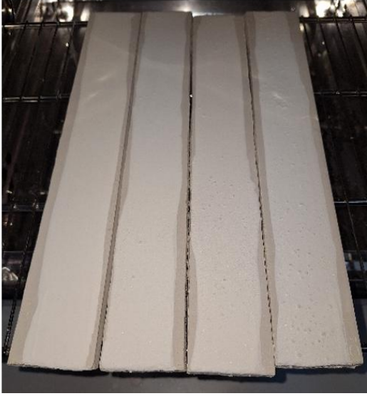
Şekil 1. Ragle ile ham sır uygulanmış karo numuneleri
