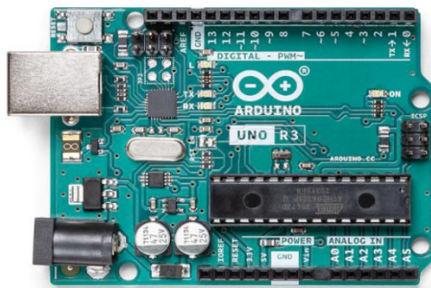
Şekil 2. Arduino Uno R3 modeli
